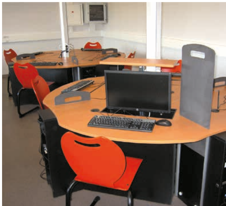
Poste marguerite avec écran sur lift, cloison de séparation, et caisson fermé à clé par une barre antivol
